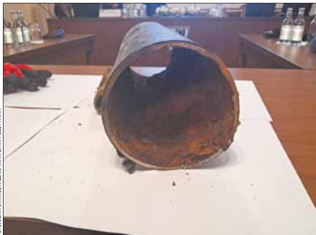
Fragment skorodowanej rury, jaki wymieniono podczas jednej z awarii sieci.
